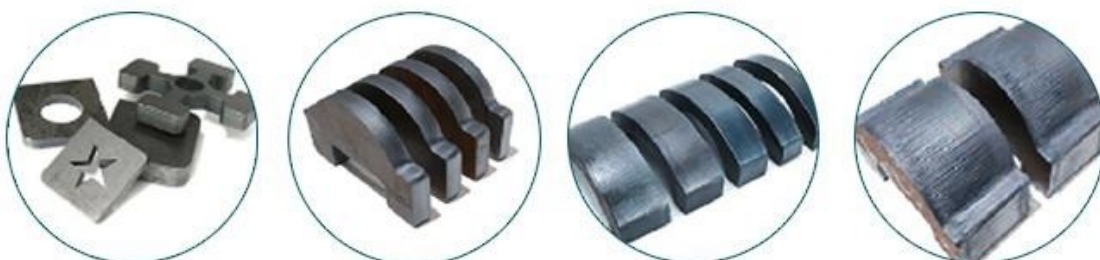
Резка углеродистой стали толщиной 6 - 50мм
