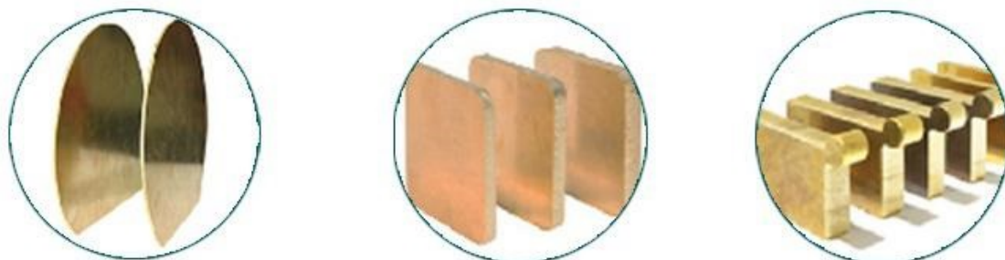
Резка латуни толщиной 1 - 14мм
