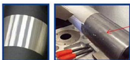
Очистка поверхностного покрытия
